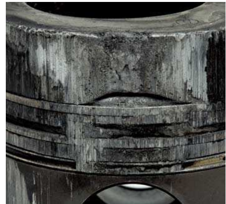
Abb. 1 Abschmelzungen am Feuersteg eines Dieselkolbens
