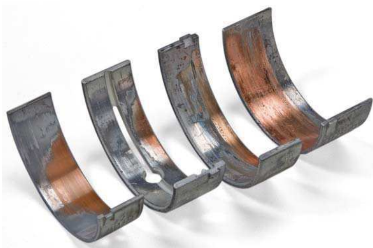
Abb. 1 Ungleichmäßiger Verschleiß an den Gleitlagern
