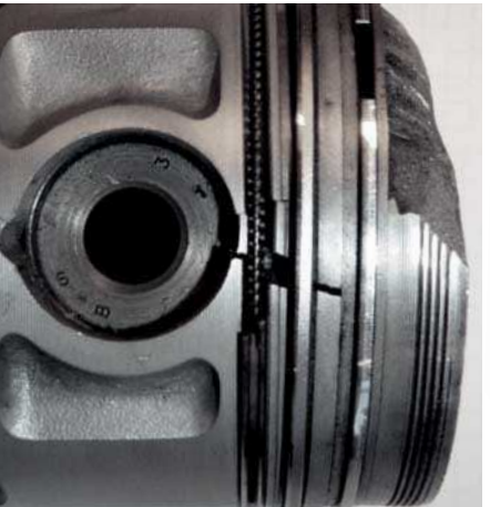
Abb. 3a Gewaltbruch vom Kolbenboden bis zur Nabenbohrung
