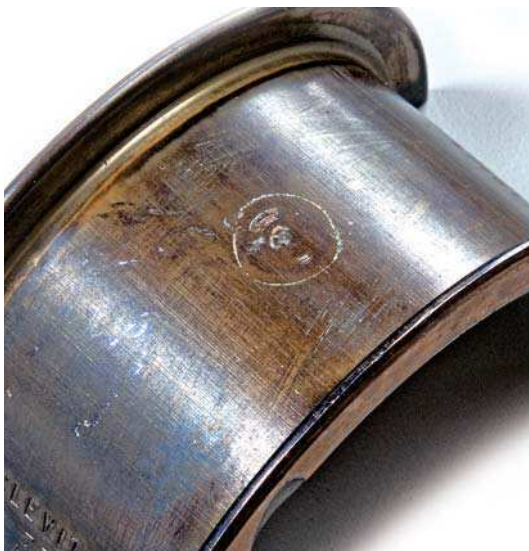
Abb. 2 Fremdkörperabdruck an der Gleitlager-Außenseite
