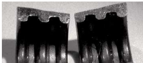
Abb. 3 Deformationen der Ventileile an den Wülsten
