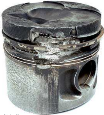
Abb. 2 Kolbenringzone mit blanker Oberfläche
