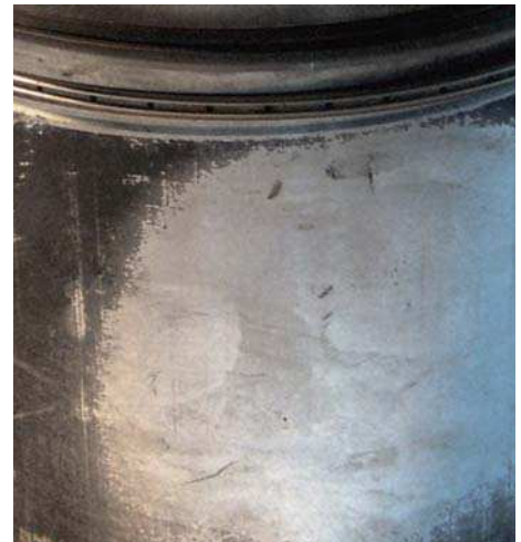
Abb. 1 Breites Tragbild und Riefen durch Kraftstoffverdünnung
