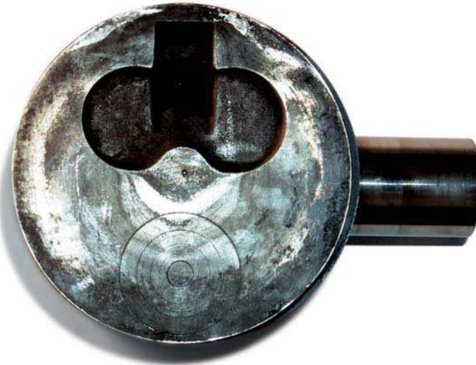
Abb. 1 Kolbenboden mit Ventilaufschlag
