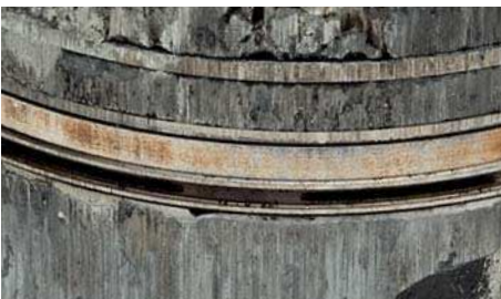
Abb. 2 Riefen und brandige Stellen an Kolbenringen
