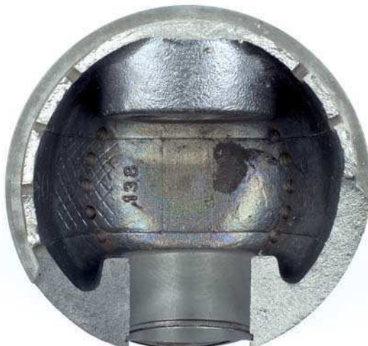
Abb. 3 Quer auf Höhe der Kolbenbolzenachse abgebrochener Kolben
