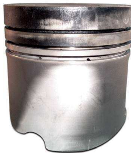
Abb. 1 Unsymmetrisches Tragbild (Schieflauf) am Kolbenschaft
