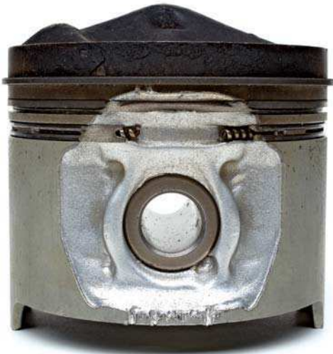
Abb. 1a Ausgekolkte Kolbenwand, verursacht durch eine lose Kolbenbolzensicherung oder Fremdkörper im Kolbenbolzen
