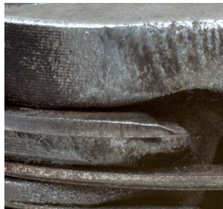
Abb. 1 Erosionsspuren am Ottokolben
