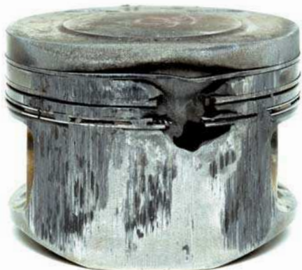
Abb. 4 Durchgeschmolzene Ringzone am Ottokolben
