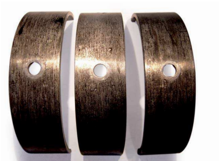
Abb. 1 Polierte Stellen an der Außenseite der Gleitlager
