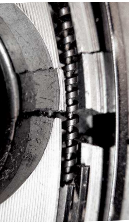
Abb. 3b Nahaufnahme eines Gewaltbruchs
