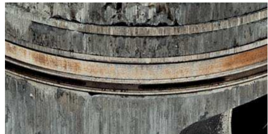
Abb. 2 Riefen und brandige Stellen an Kolbenringen
