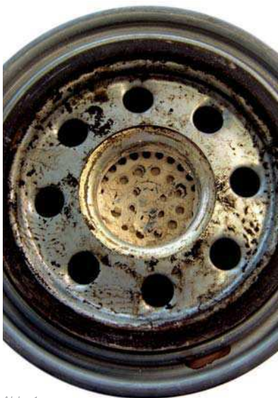
Abb. 1 Granulataustritt aus der Lufttrockner-Patrone
