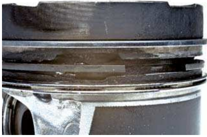
Abb. 1 Stark ausgearbeitete Kolbenringnut
