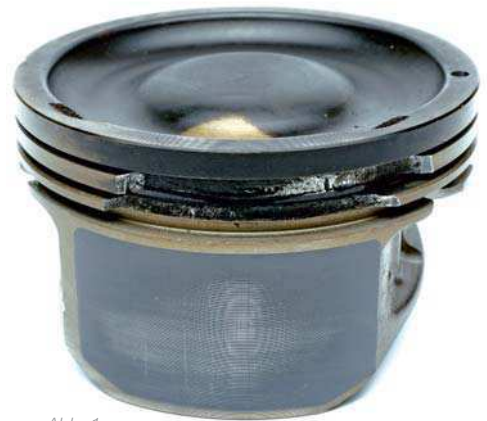
Abb. 1a Gebrochene Kolbenringstege durch Störung im Verbrennungsprozess
