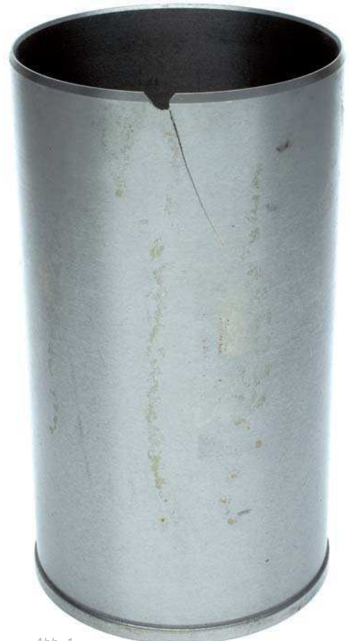
Abb. 1 Unteres Ende der Zylinderlaufbuchse mit Längsriss
