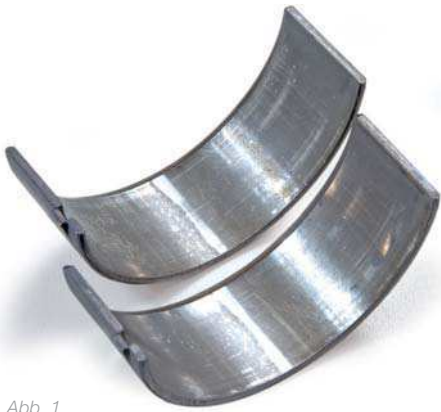
Abb. 1 Glänzende Stellen an den Laufflächen der Lagerschalen
