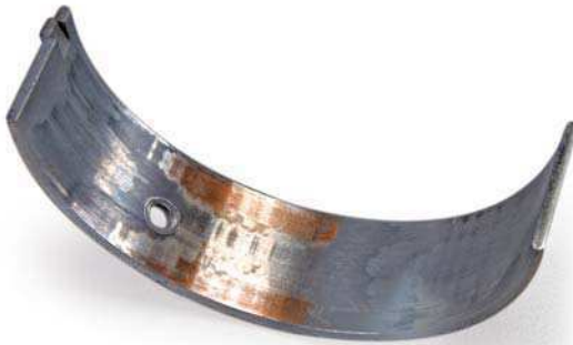
Abb. 1 Ungleichmäßiger Verschleiß an den Lagerschalen, Laufschrift zum Teil abgetragen
