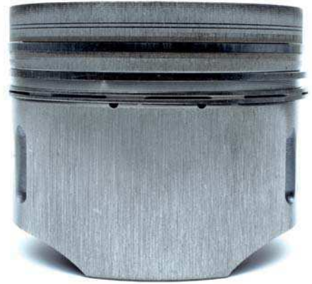
Abb. 1 Schmutzverschleiß am Kolben – starke Riefen in Längsrichtung
