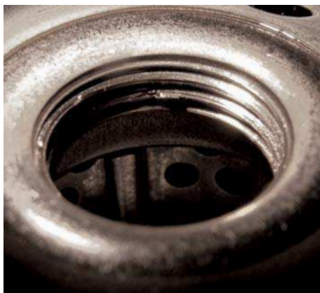
Abb. 5 Beschädigte Gewindegänge aufgrund eines schräg angeschraubten Filters
