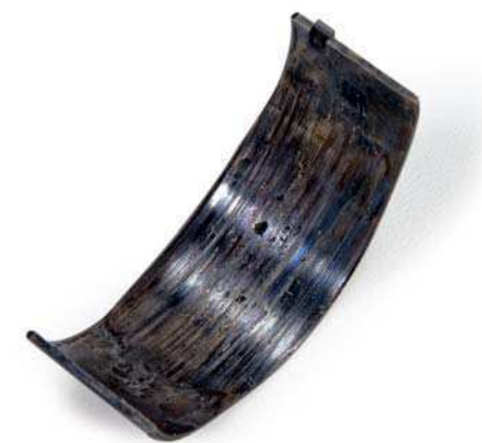
Abb. 2 Stark verschlissenes und ausgeschlagenes Gleitlager
