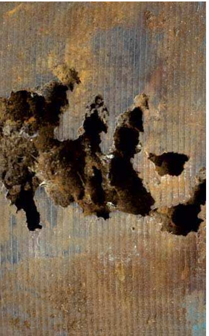
Abb. 1b Nahaufnahme der Zylinderlaufbuchse mit scharfen Kanten und nach innen größer werdenden Löchern
