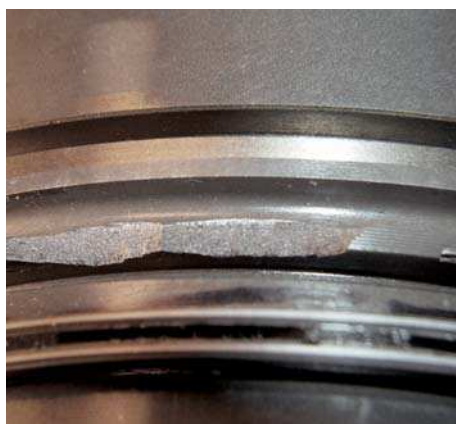
Abb. 2 Gebrochene Kolbenringstege durch Montagefehler
