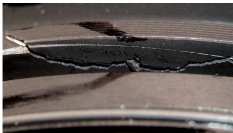
Abb. 3 Montagefehler mit Abdruck des Kolbenrings
