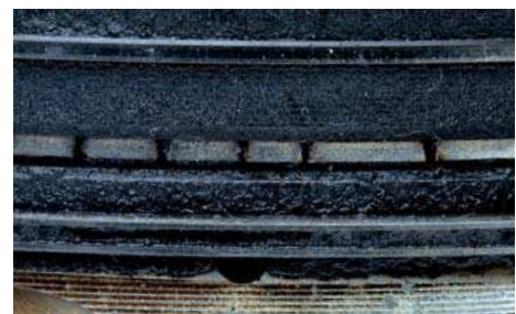
Abb. 4b Nahaufnahme eines Kolbenringbruchs
