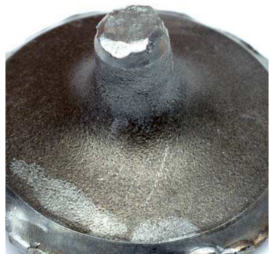
Abb. 3 Schwingungsbruch mit Bruchfläche am Ventilschaft
