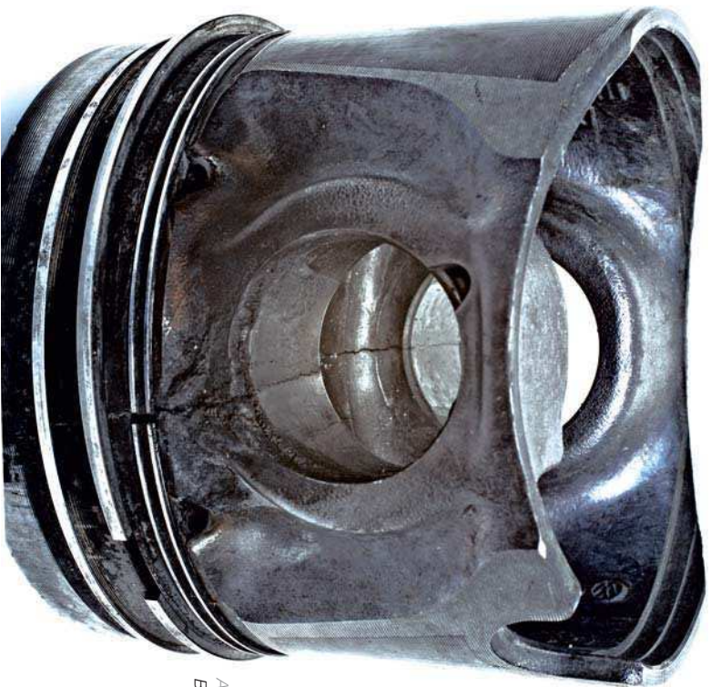
Abb. 2 Bis in die Nebenbohrung gebrochener Kolben
