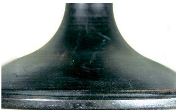
Abb. 1 Deformierter Ventilteller (Tulpenform)
