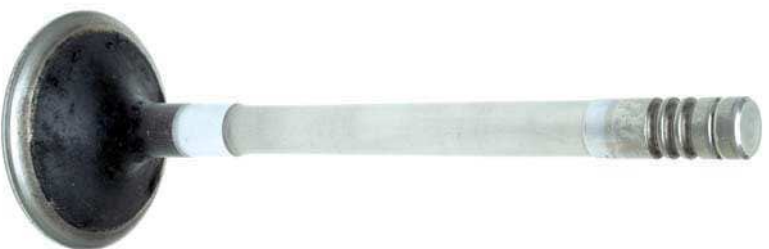
Abb. 7 Stark verschlissener Ventilschaft
