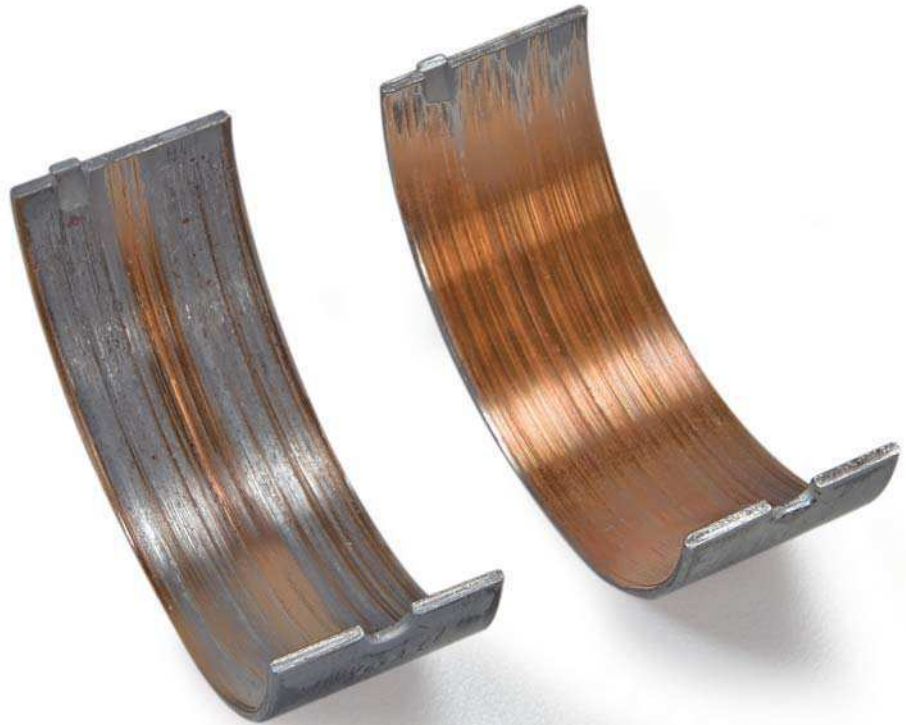
Abb. 1 Starke Riefen in Umfangsrichtung
