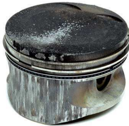
Abb. 3 Starke Erosionsspuren und Abschmelzungen am Kolbenkopf
