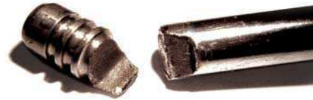
Abb. 2 In der Rille gebrochener Ventifuß (Gewaltbruch/Biegebeanspruchung)
