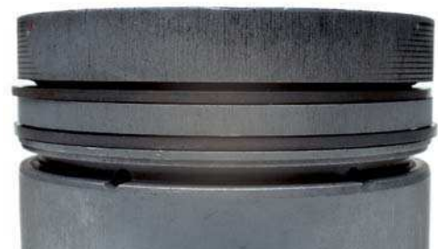
Abb. 2 Starker Axialverschleiß besonders am 1. Kolbenring
