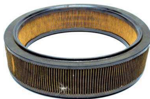
Abb. 3a Stark verschmutzter Luftfiltereinsatz, Wechsel unbedingt erforderlich
