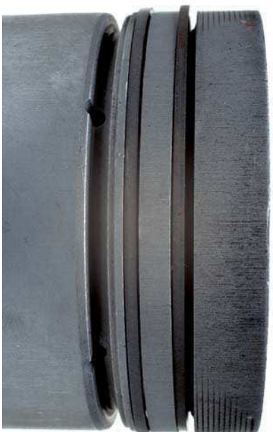
Abb. 4 Axialverschleiß der Kolbenringe
