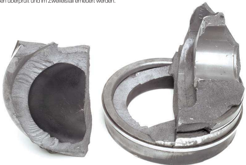
Abb. 1 Durch Flüssigkeitsschlag zerborstener Nz-Kolben
