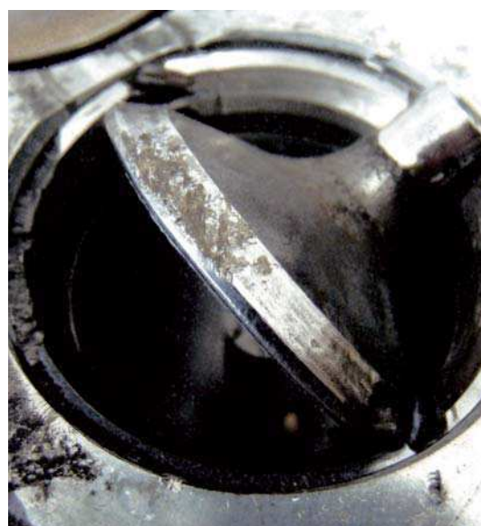
Abb. 1 Im Bereich des Ventiltellers abgerissenes Ventil
