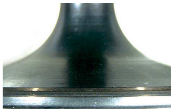
Abb. 2 Zum Vergleich: Ventilteller ohne Verformungen
