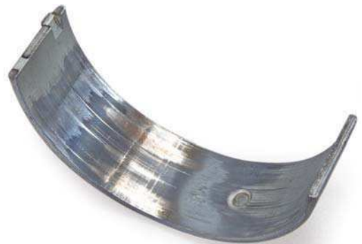
Abb. 2 Ungleichmäßiger Verschleiß an den Lagerschalen
