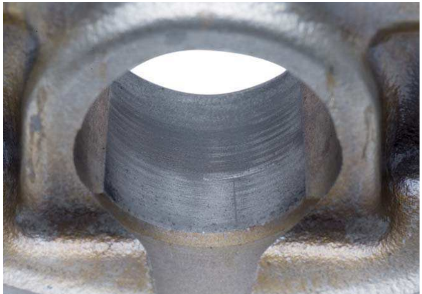
Abb. 1 Fresser in der Nabenbohrung
