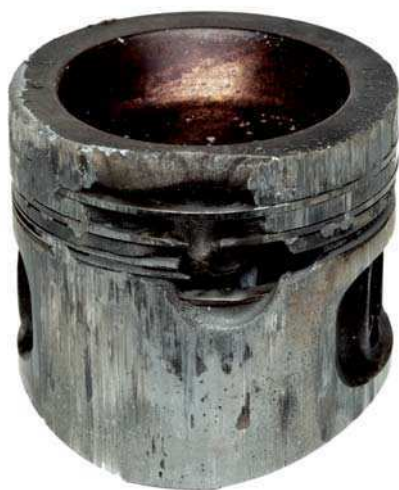
Abb. 2 Abgeschmolzener Feuersteg am Ottokolben
