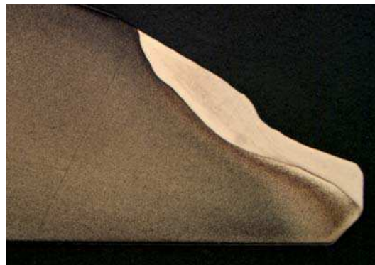
Abb. 3 Extrem abgenutzte Dichtfläche (stellitgepanzert)
