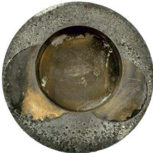
Abb. 2 Gegen Zylinderkopf gelaufener Kolben
