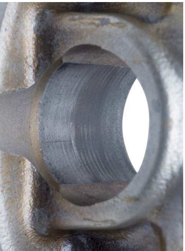
Abb. 3 Nebenbohrung mit Fressspuren
