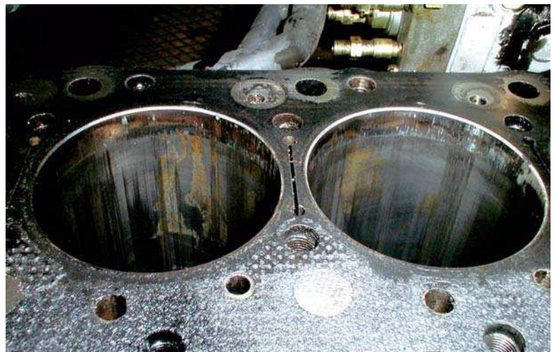
Abb. 2 Zylinderbohrung mit Längsriefen
