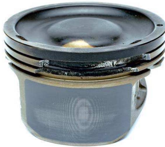
Abb. 2a Gebrochene Kolbenringstege
