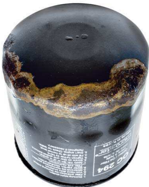
Abb. 4 Beschädigte Beschichtung – die Folge: Korrosion
