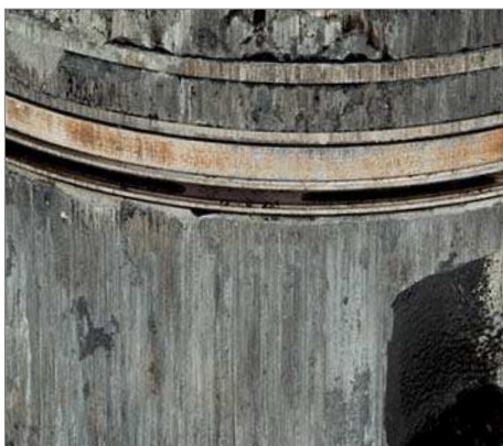
Abb. 2 Kolbenringe mit brandigen Stellen
