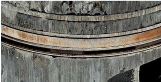
Abb. 2 Riefen und brandige Stellen an Kolbenringen
