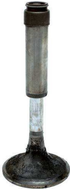
Abb. 1a Ventil, das in der Führung gefressen hat
