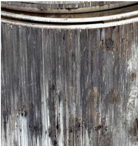
Abb. 1 Einseitiger Fresser auf der Druckseite am Kolbenschaff
